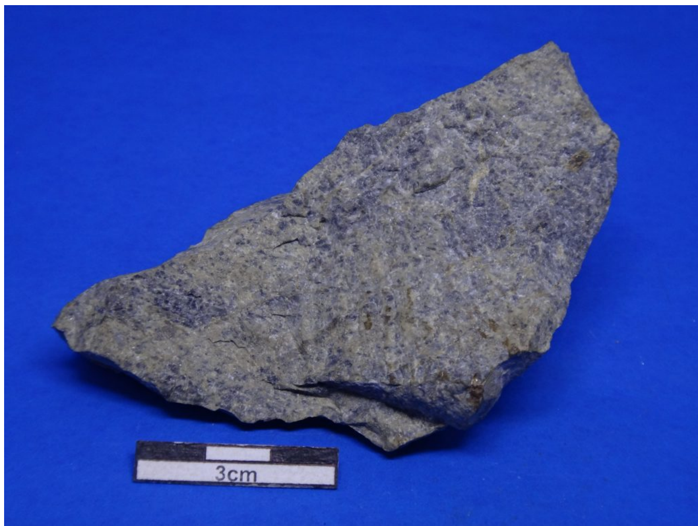
MAG-2. esfalerita finamente disseminada em dolarenito
