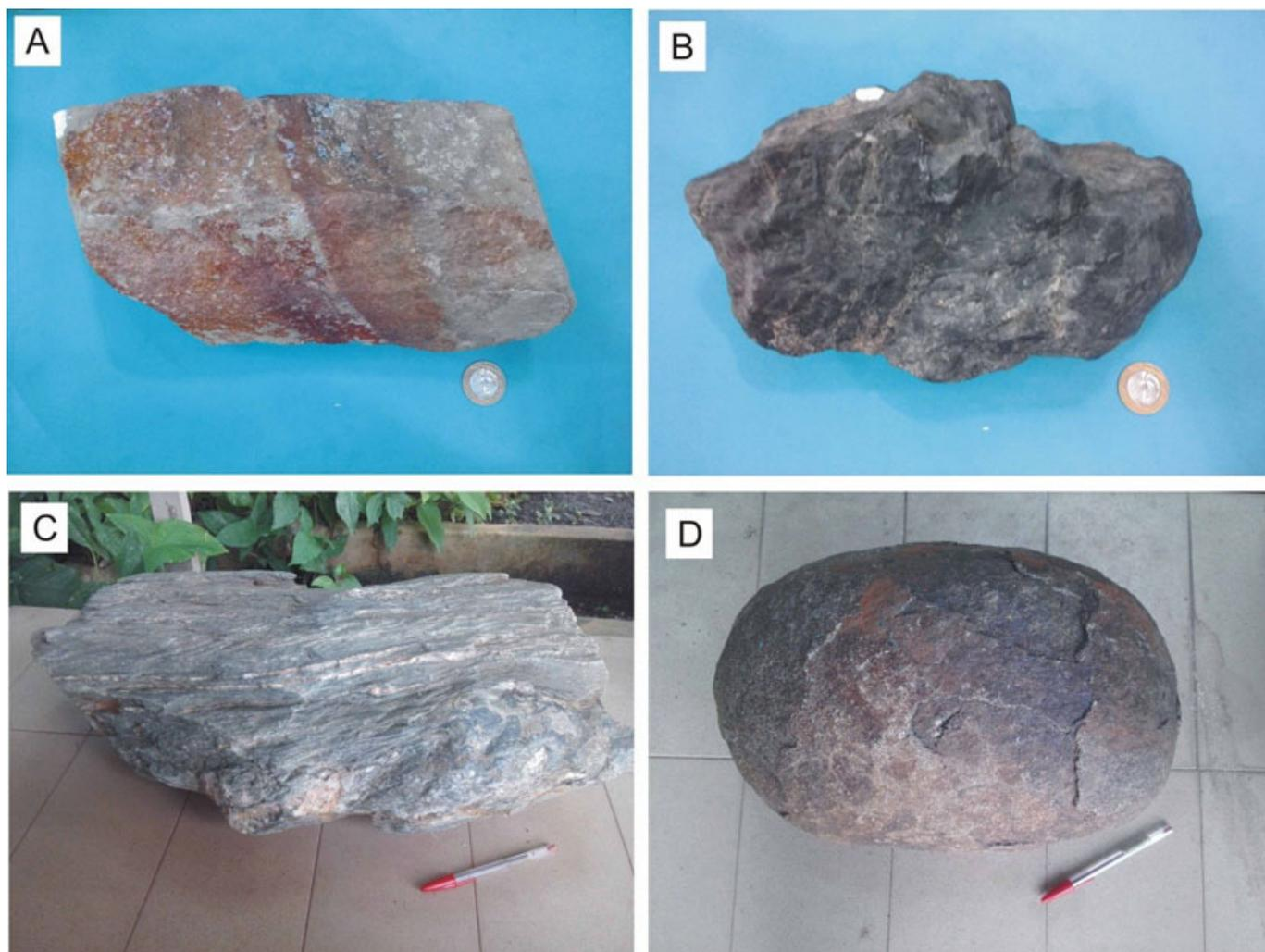
Figura 1. Opala em disjunção colunar (A); quartzo negro (B); Xisto (C); esfoliação esferoidal em basalto (D).
