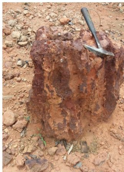
Crosta laterítica ferroaluminosa colunar gibbsítica em monumento em frente à Câmara. 20.10.2018.
