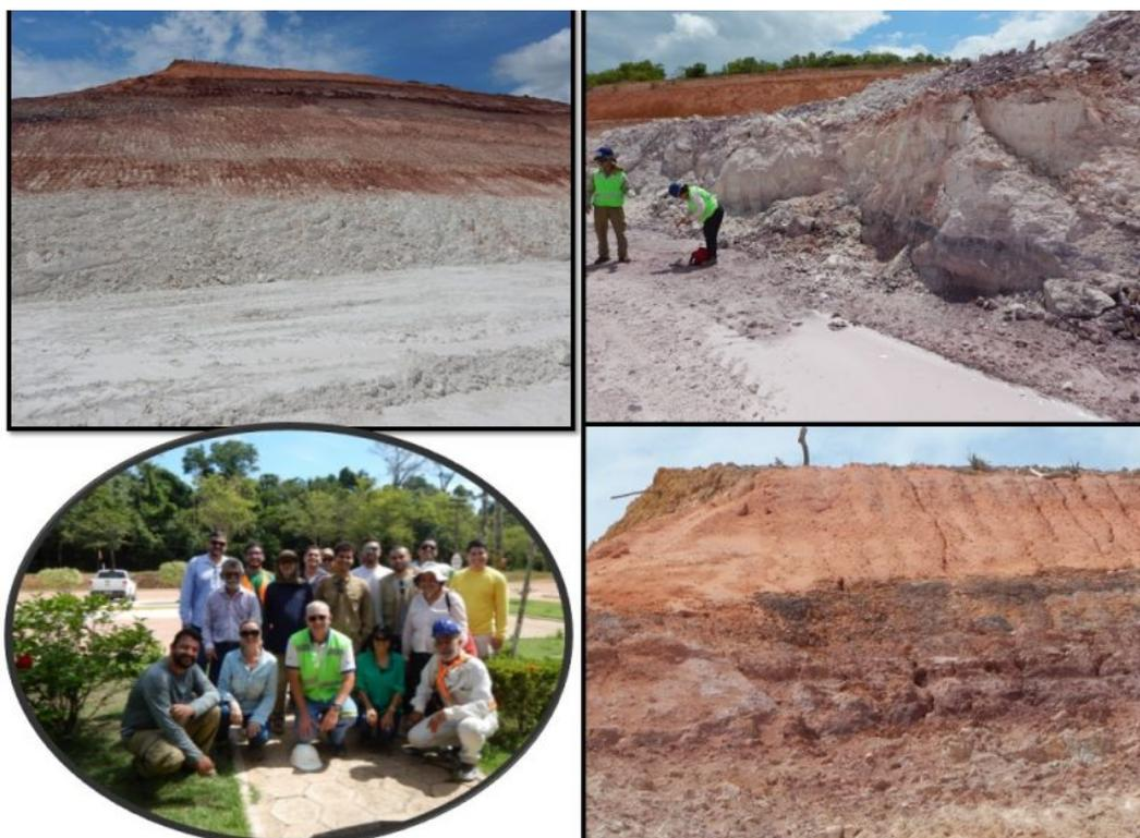
Figura 4 – Imagens na mina de caulim da PPSA. No sentido horário: a frente de lavra com o caulim na base; caulim em contato com argilitos laminados roxos; contato da Formação Barreiras com o perfil laterítico maturo subjacente; a equipe com o geol. Eric Sennavoine (ao centro, agachado, com colete verde) da IMERYS.
