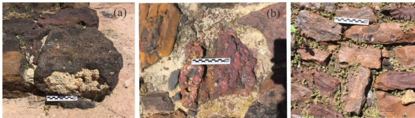
Figura 4: Rochas predominantes do contexto geológico amazônico, encontradas nas ruínas remanescentes do Forte São Pedro Nolasco e de suas estruturas internas em Belém/PA: (a) arenito ferruginizado; (b) crosta laterítica; (c) pedra de ferro.
