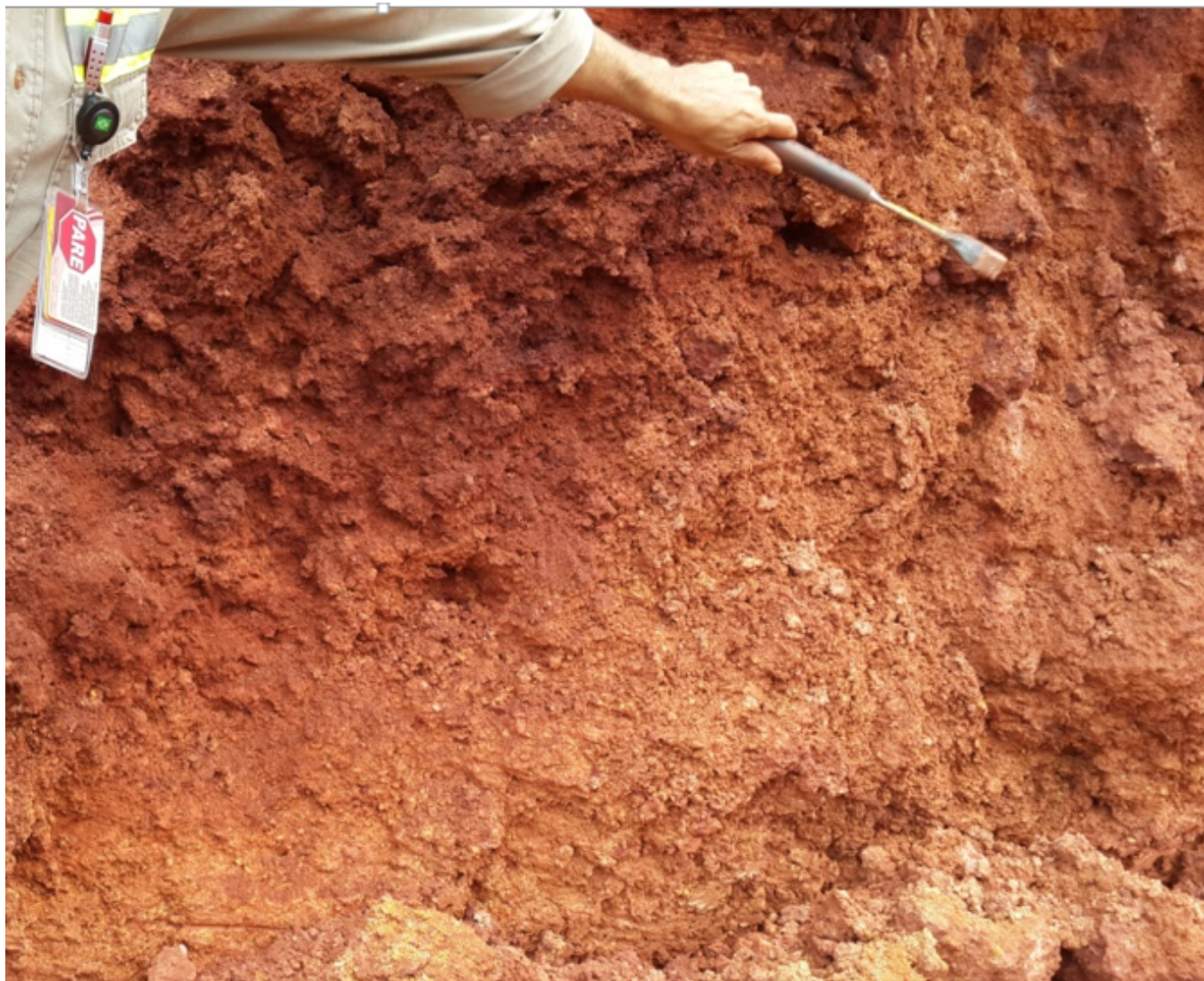
Figura 2. Frente de lavra da mina Bela Cruz mostrando a zona mineralizada em bauxita nodular.
