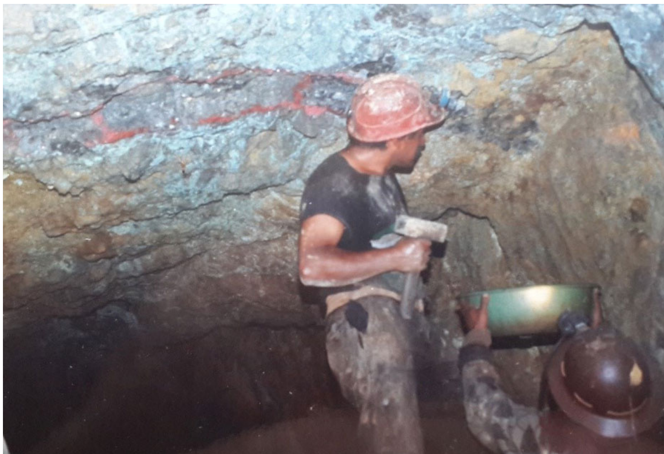
Figura 2. Vetas hidrotermales donde ocurre los sulfosales.
