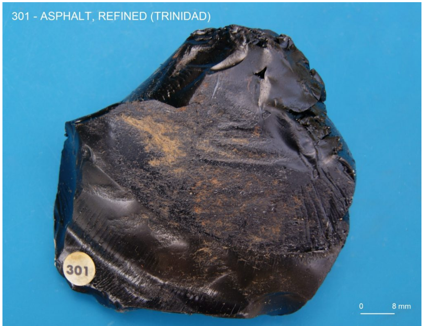
301 - ASPHALT, REFINED (TRINIDAD)
