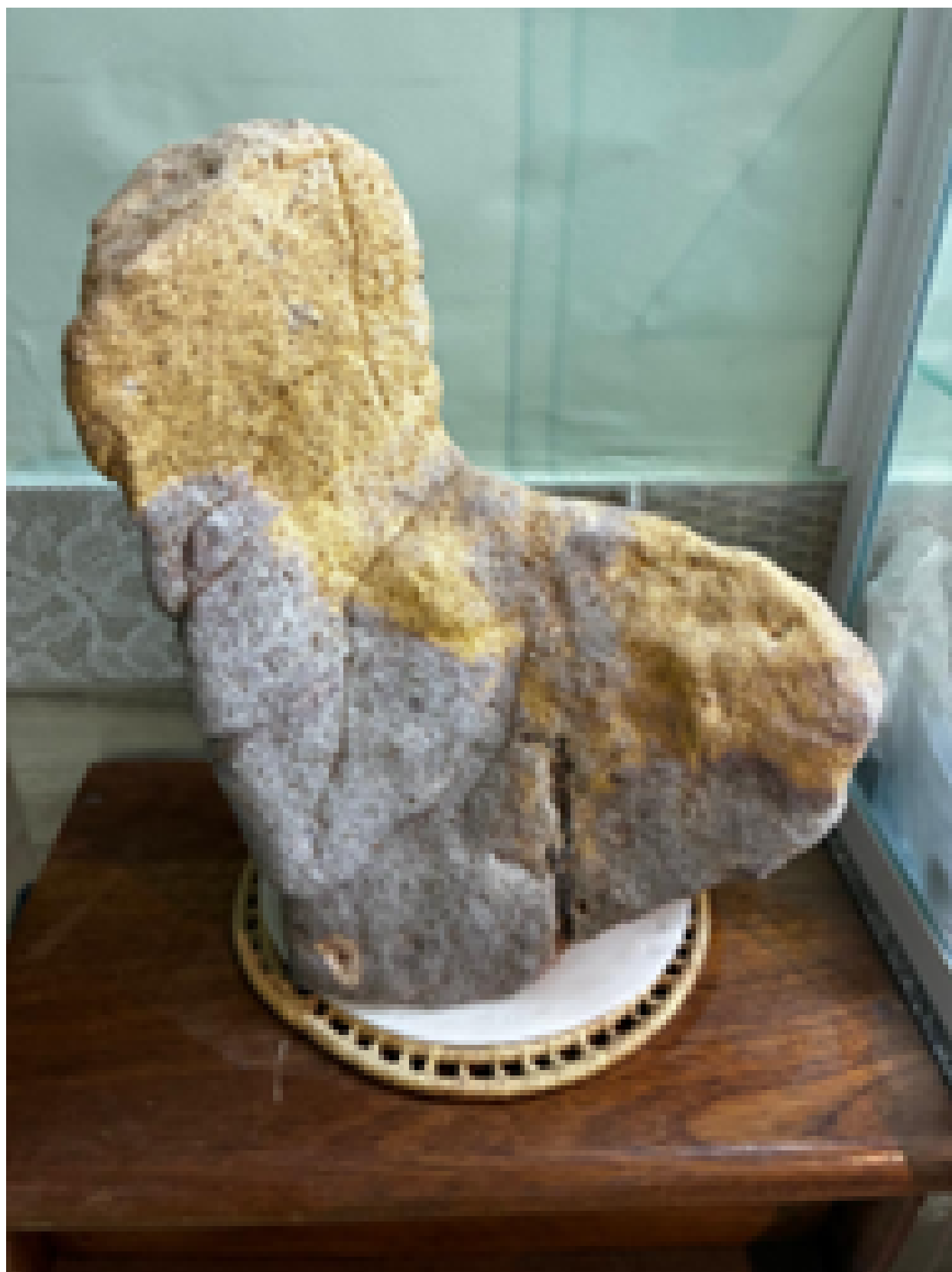
Figura 18 - Amostra coletada na zona mosqueada de perfil laterítico com domínios de hematita (porção lilás) e de goethita aluminosa (porção ocre) coletada na praia de Ponta Grossa – Icapuí-CE.
