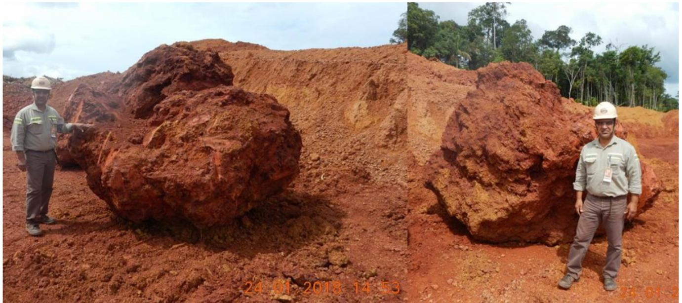
Bloco Trombetão ou Bauxitão do Trombetas ainda na mina de bauxita de Porto Trombetas, uma doação da Mineração Rio do Norte-MRN, aguardando despacho para Belém do Pará. Mineralogia: gibbsita, hematita e anatásio, muito pouco caulinita e quase nada de quartzo (segundo DRX, MEV/EDS, ATD/TG e análises químicas totais). Imagem enviada pelo geólogo Marco Andre Heidtmann Monteiro.
