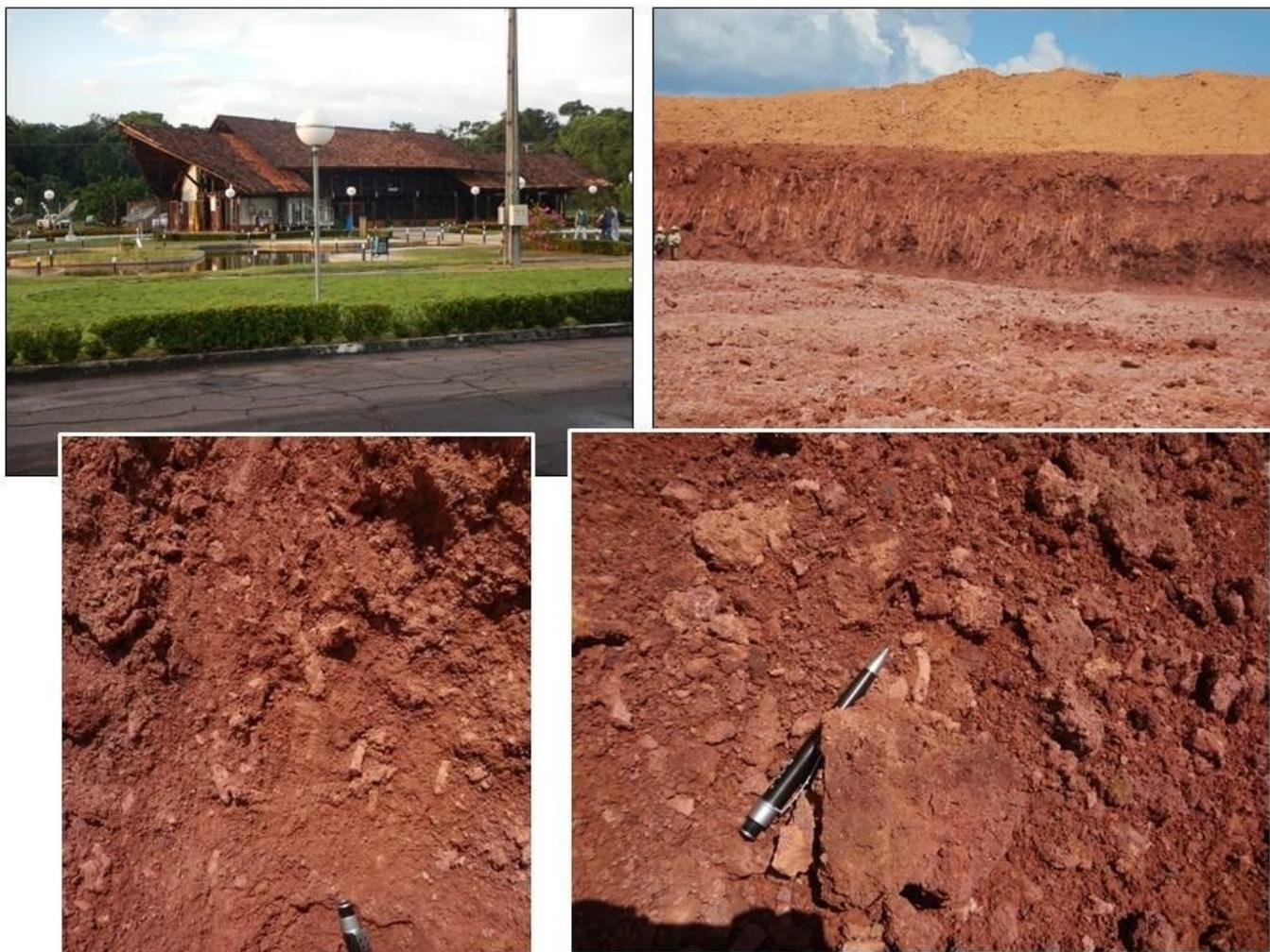
Figura 1. Acima à esquerda o Aeroporto de Trombetas; à direita o espesso corpo bauxítico com cobertura tipo Argila de Belterra do platô Bela Cruz; abaixo à direita detalhe da bauxita sacaroidal, em parte friável, com algumas raízes gibbsitizadas; à esquerda profusão de raízes gibbsitizadas em matriz sacaroidal a argilosa.
